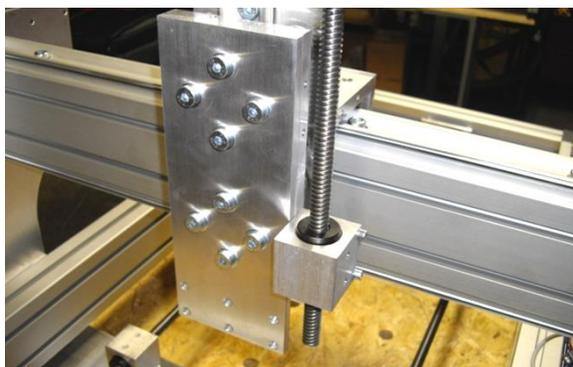
Abbildung 26: Grundplatte Z Spindelhalter am Gewindemutterhalter befestigt
