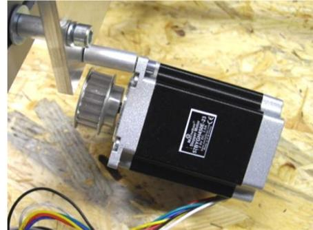
Abbildung 12: Motor an Motorplatte Y anschrauben
