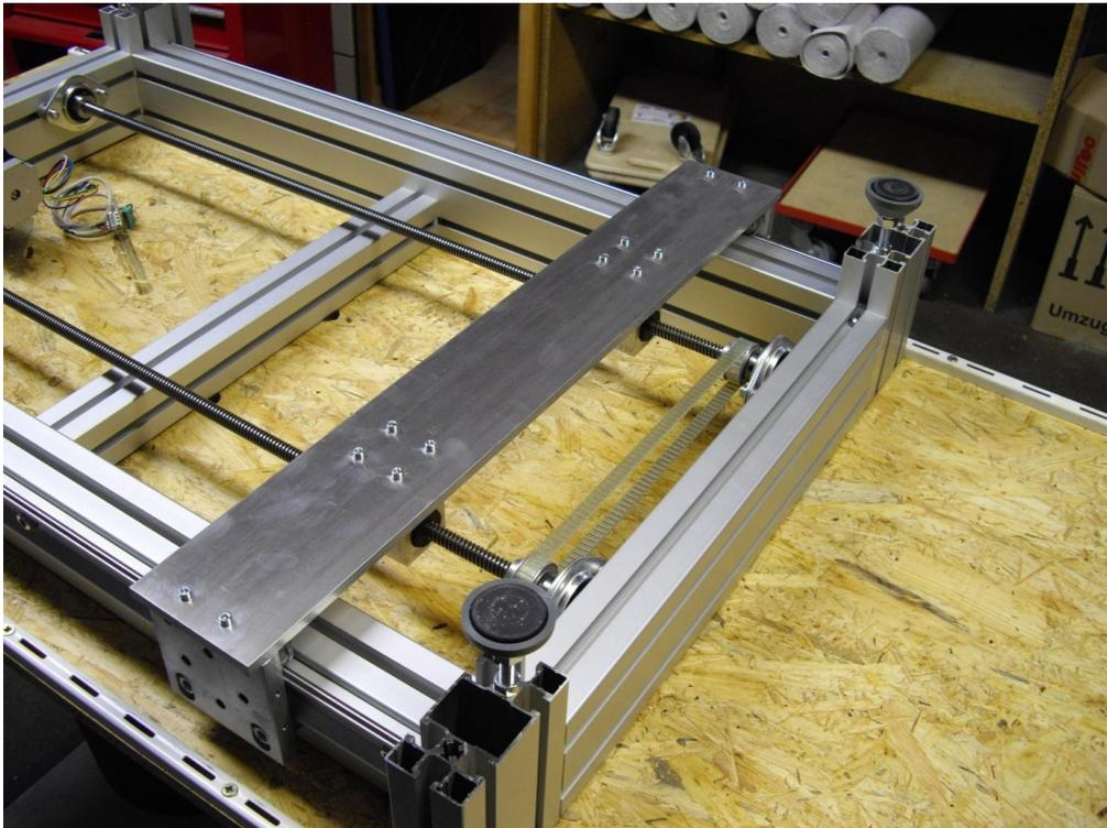
Abbildung 14: Verbindung Seitenteile an den Gewindemuttern M4 und den Laufwagen befestigt
