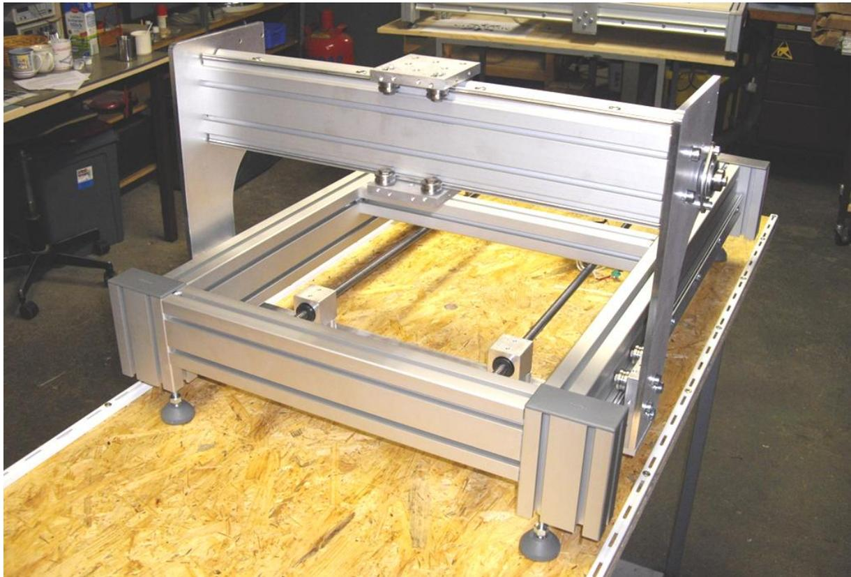
Abbildung 17: Portal mit Führungsschienen X und Laufwagen montiert
