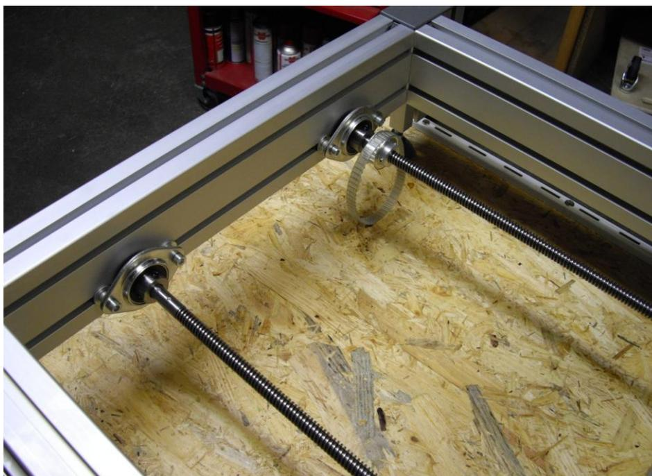
Abbildung 8: Gewindespindeln der Y-Achse montiert
