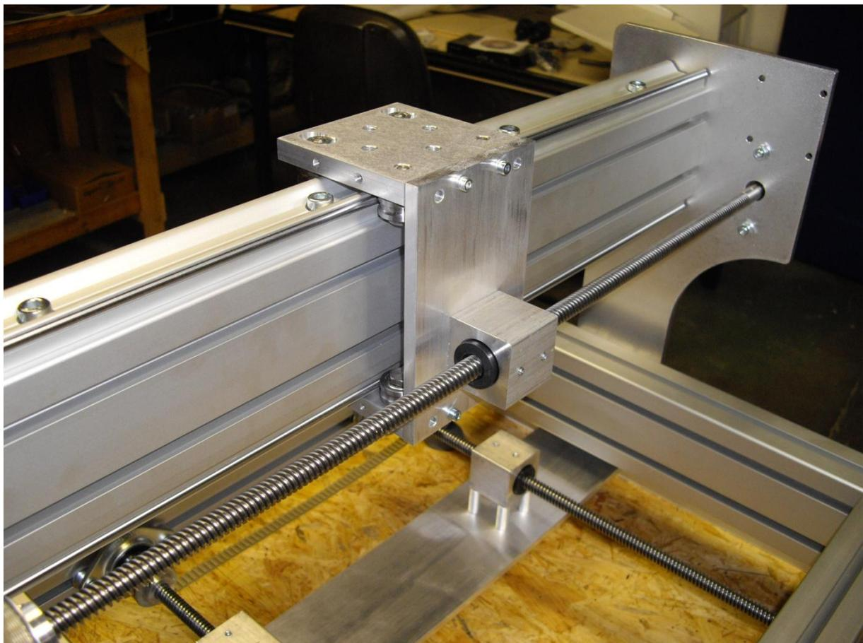
Abbildung 19: Grundplatte X hinten montiert
