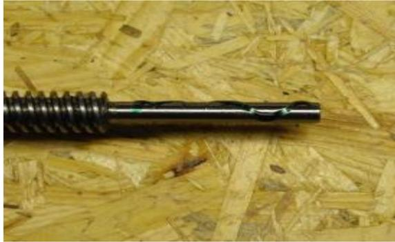
Abbildung 5: Schraubensicherungslack an den Enden der Spindeln
