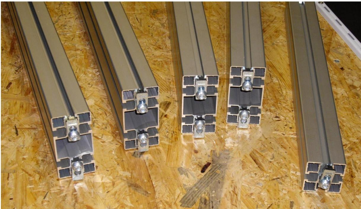
Abbildung 1: Profilverbinder in Rahmenteile Stirnseite, Rahmenteil Seiten und Strebe Arbeitsfläche einschrauben
