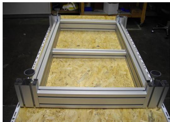
Abbildung 2: Montierter Rahmen einer CNC-Maschine vom Typ Pro Serie 06-05
