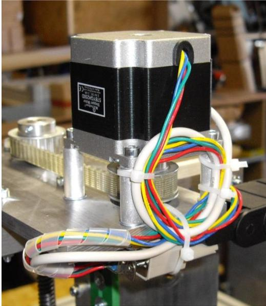
Abbildung 35: Kabel am Motor Z
