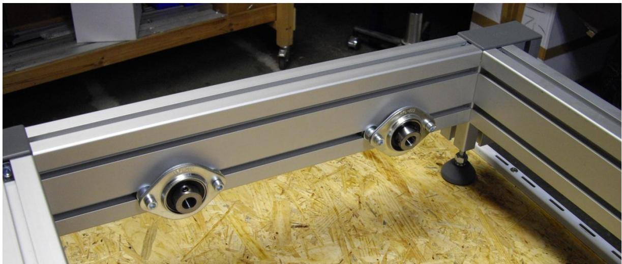
Abbildung 4: Zwei Flanschlager montiert
