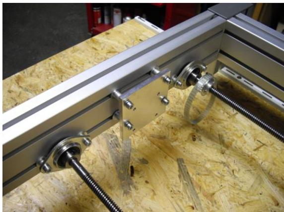
Abbildung 9: Motorplatte Y montiert
