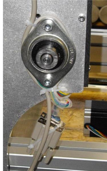
Abbildung 36: Kabelführung um das Flanschlager
