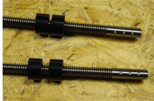
Abbildung 6: Hülsen aufschieben und Madenschrauben festziehen
